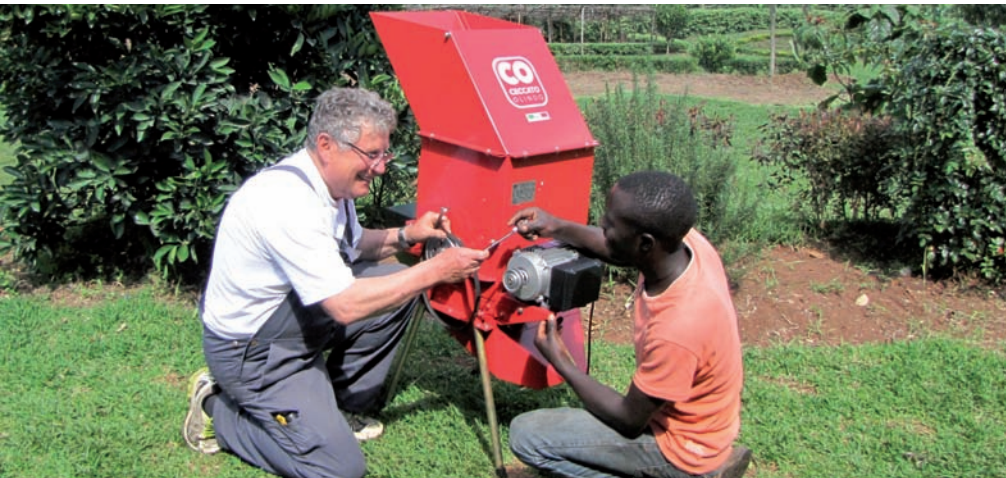
Uganda: Norbert Wolff hilft beim Wechsel eines Keilriemens. Schulungs- und Wartungsarbeiten standen im Mittelpunkt seines Einsatzes im Lebenshaus von Masaka.
